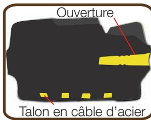
La profondeur de gomme importante sur la bande de roulement assure une plus longue durée de vie au pneu.
