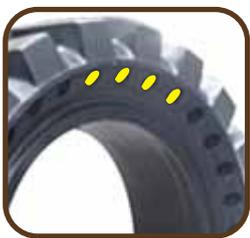
Les alvéoles du pneumatique lui assure un meilleur confort de conduite et une dissipation importante de la chaleur.
