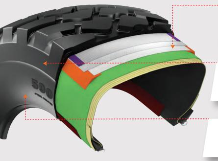
Construction radiale avec trois ceintures en acier pour améliorer la durabilité, la protection contre les crevaisons et la faible résistance de roulage
